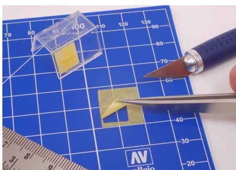
**8** La retiramos y cortamos con precisión sobre superficie de corte. Separamos la cinta con la ayuda de unas pinzas de Vallejo T12003.
