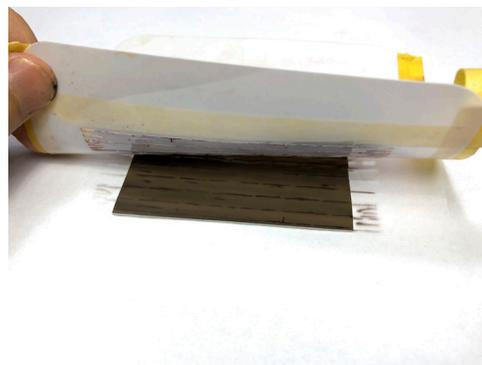
4 Con la referencia ST-TX006 Vetas de madera N°1 y cinta de enmascarar, se fija la plantilla al trozo de madera.
