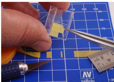
**5** Y de nuevo cortamos el trozo de máscara con una medida inferior. Una plancha de corte y una cuchilla nueva en nuestro cutter es fundamental para realizar un trabajo preciso.
