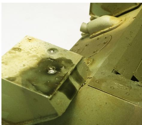
**5** Utilizando un pincel aplicaremos Petrol Spills sobre los depósitos adicionales del carro lanzallamas, especialmente alrededor de los tapones.
