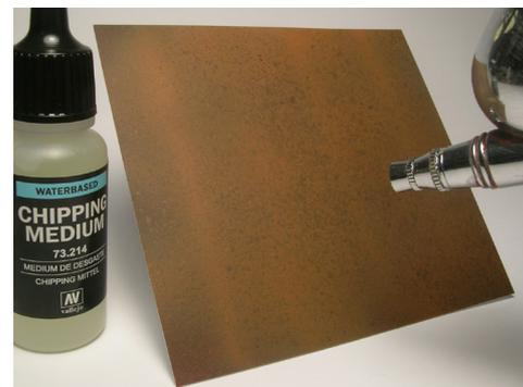
6 En este paso se añade una capa uniforme de Chipping Medium 73.214 usando el aerógrafo.
