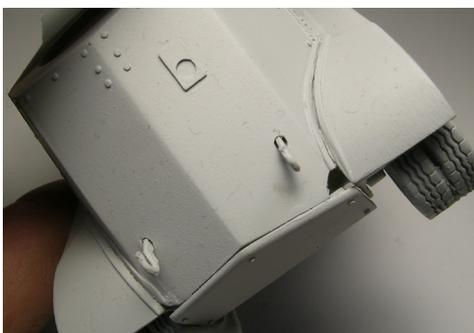
**14** Un orificio en la parte trasera tal vez debido al molde de la resina debe rellenarse y lijarse una vez la masilla plástica esté perfectamente seca.
