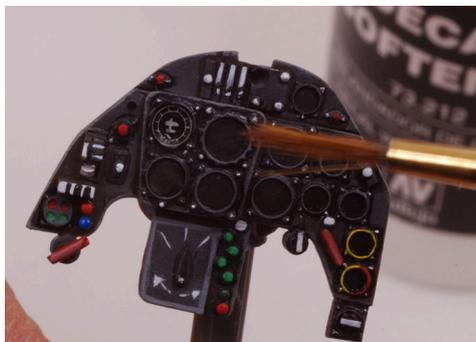
11 A continuación, se coloca la calca y sobre esta una gota de Decal Softener 73.212. La función de este líquido es adaptar la calca a las irregularidades y relieve de la superficie.
